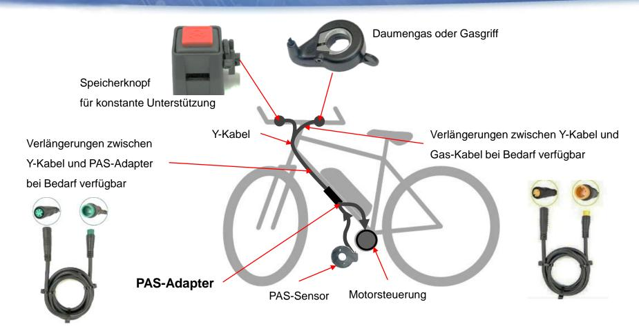
Alle Kabel mit Kabelbinder am Rahmen fixieren.
