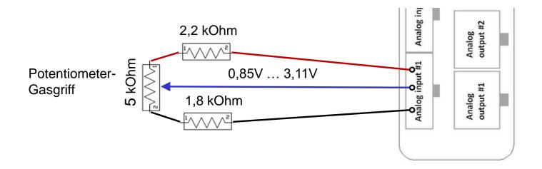
Bei einem DMMD für Potentiometer-Gasgriff ist für eine nachträgliche Umrüstung von **Potentiometer-Gasgriff auf Hallgasgriff** eine Neukonfiguration des DMMD erforderlich.
