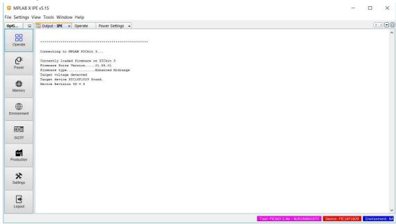
Falls hier eine Fehlermeldung (Target device was not found) erscheint, ist vermutlich der ThermoMonitor nicht mit dem Programmiergerät verbunden oder der ThermoMonitor ist noch ausgeschaltet.
